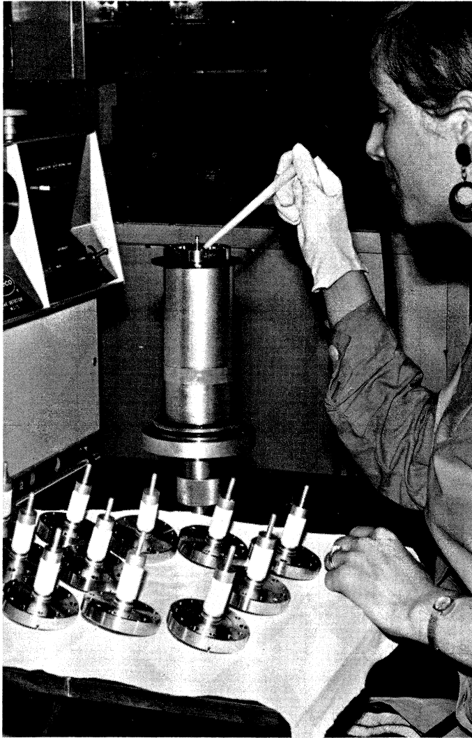
Contrôle d'étanchéité des 1500 traversées étanches équipant les anneaux de stockage. Service ISR.
